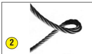
A **figura 3** mostra o resultado do nó, pois, mesmo que os arames individuais não tenham sido prejudicados, o cabo de aço perde sua forma adequada. Com os arames e as pernas fora da posição, o cabo de aço está sujeito à tensão desigual, expondo o mesmo à ruptura por sobrecarga além de causar desgaste excessivo às pernas deslocadas.
